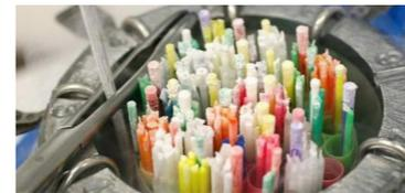
Cuve d'azote liquide (-196°C) et paillettes
